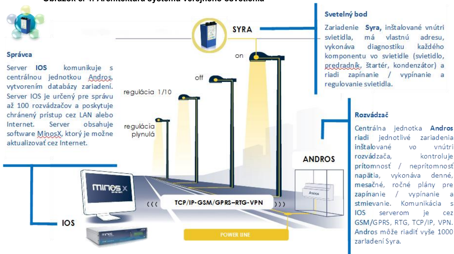
Obrázok č. 4: Architektúra systému verejného osvetlenia
